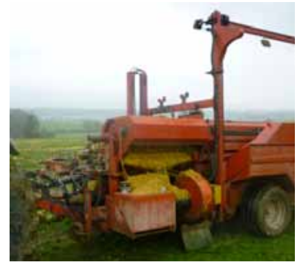
Au devant, la turbine aspire une grande quantité d'impuretés. À l'arrière, le tank de stockage peut contenir 1200 g de graines.
