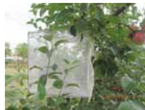
Figure 1: Cage de petit volume, de 35 cm de côté, entourée d'un tissu polyester de type moustiquaire d'une maille de 1,5 mm.
