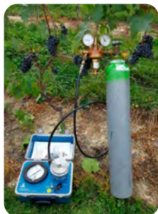
Figure 1 : A gauche, la chambre à pression osmotique (de Scholander) qui sert à mesurer le potentiel hydrique et, à droite, le N-Tester qui permet de mesurer le taux d'azote.
