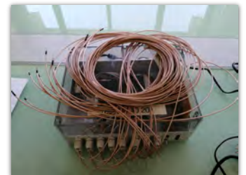
Boîtier de mesure électro-physiologique avec les câbles et les électrodes à leurs bouts (Antoine Chandelier, 2019)
