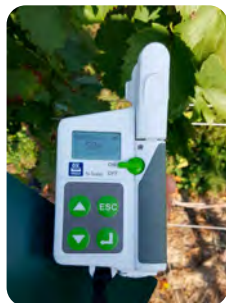
Figure 1 : A gauche, la chambre à pression osmotique (de Scholander) qui sert à mesurer le potentiel hydrique et, à droite, le N-Tester qui permet de mesurer le taux d'azote.
