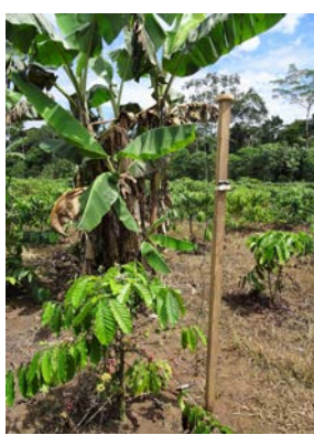
Pyranomètre prêt à l'utilisation, le capteur se trouve au sommet du poteau (photo personnelle)
